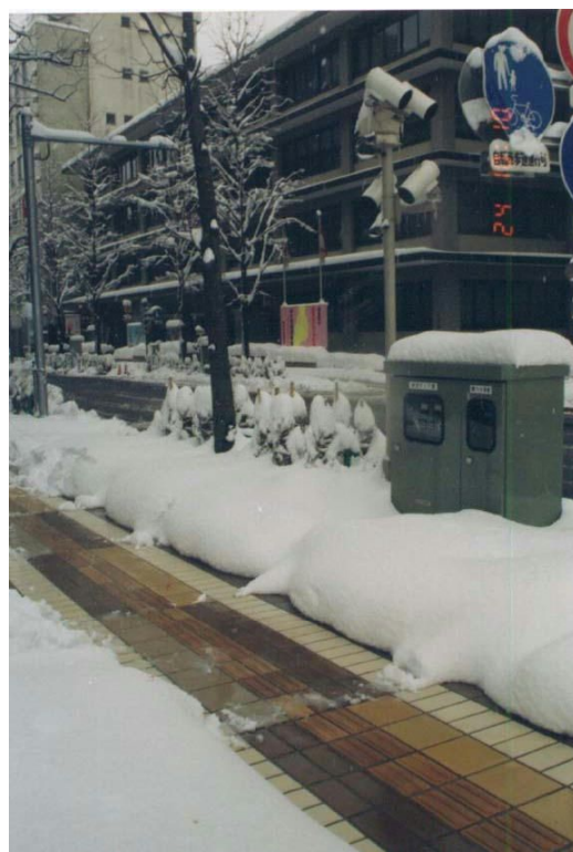
写真-4.2 高熱伝導融雪パネルブロックと 積雪センサー
