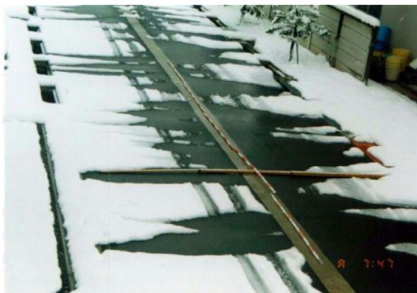
写真-3.3 ノズル散水での路面状況
