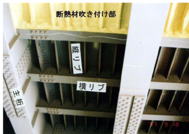
写真-9.5 開断面リブ鋼床版橋とその断熱実験
