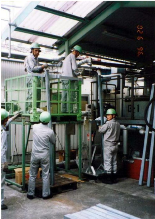
写真-11.1 潜熱蓄熱材の鋼管への注入
