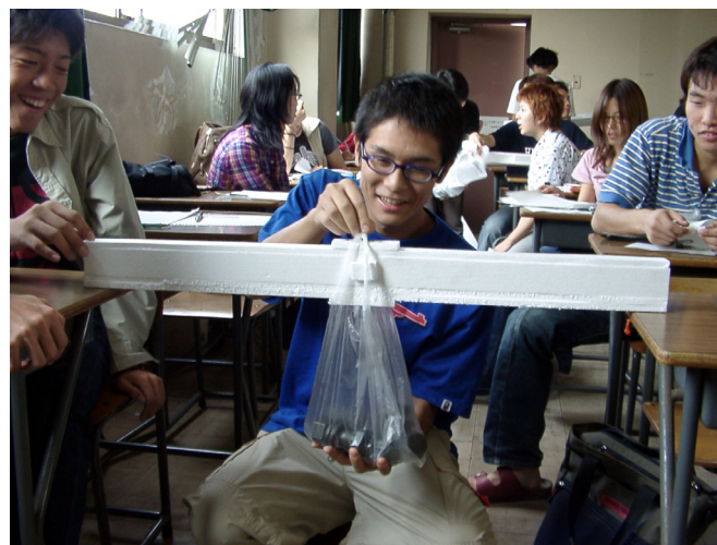
図16: 発泡スチロール梁の強度実験コンテスト
