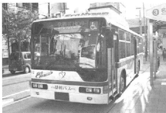
写真1 シリーズハイブリッドシステムを搭載したバス
