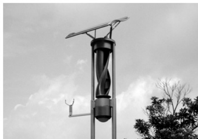
図3 サボニウス型風車
