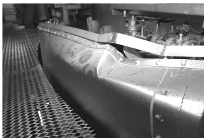
写真4 破損した2号溶融炉（2004年1月）
