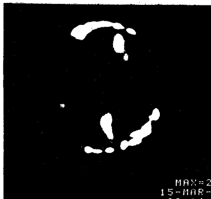
図 5.16: ACC 試験の各経過時間での EL 像 (300 K, LED mode, J=1.0 \text{ kA/cm}^2 )
