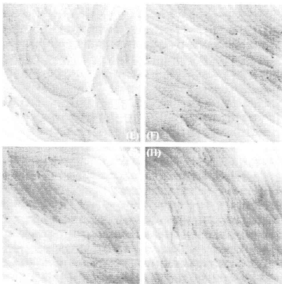
図 2.9 n-GaN の AFM による表面モフォロジー (測定領域は全て 3\ \mu\text{m} \times 3\ \mu\text{m} )
