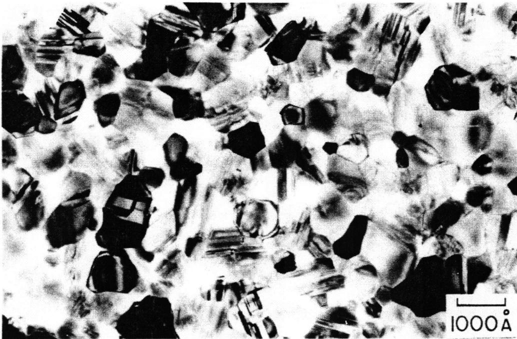
図2-9 電子ビーム同時蒸着 $\text{MoSi}_2$ 膜 1000°C、30分熱処理後のTEM明視野像。
