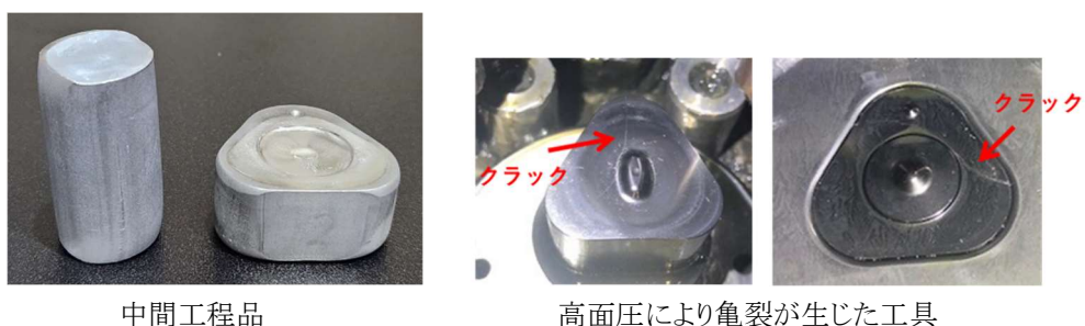
Fig. 5.1 中間工程品と工具の破損事例
