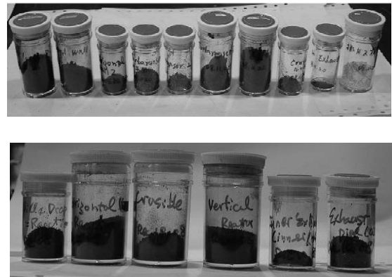
図 7 実験終了後反応管の各所から採集したサンプル（上図は垂直反応管温度が 950°C、下図は 1000°C）
