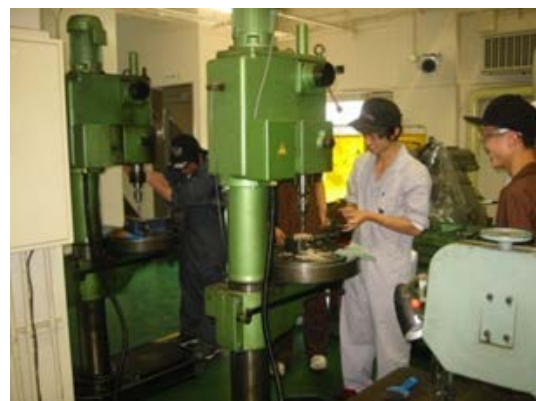
ボール盤作業をする受講者
