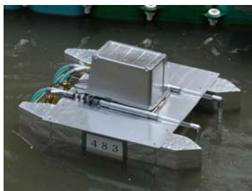
483 ギンギラギン ポンプで微細気泡を発生させな がら進行する船
