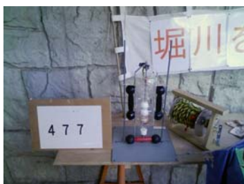
477 見太郎----- (みたろう) 空ボトルで底層水を採水する、観測用ロボット
