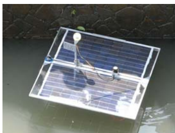
468 Becken (ベッケン) 超音波ソナーを用いて、川底地図を作成するタライ型ロボット
