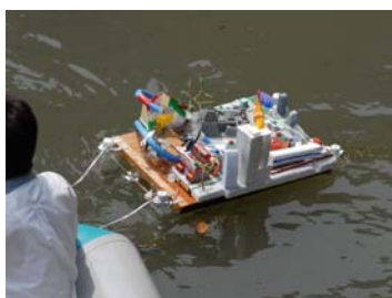
471 アトランティス 水車で水を浄化するロボット
