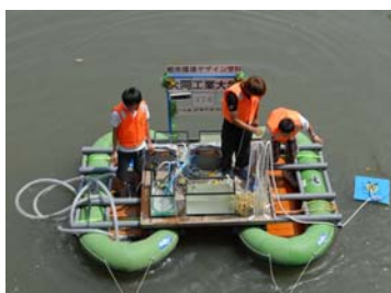
476 ヘドロ水浄化ロボット ウォーターエコ3号 凝集剤によってヘドロと河川水を分離させる水質浄化ロボット
