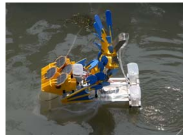
453 魚虎(しゃちほこ) ラジコンで遠隔操作し、川を流れているゴミを回収するロボット
