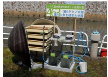
463 シジミ型水質浄化ロボット改良Ⅱ型 貝などの生物を使って水中の浮遊物を取り除き水質を改善するロボット
