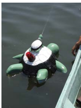
358 パトカメ 水の重さを利用して浮き沈みしながら川を監視する亀型ロボット
