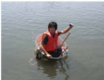
332 新型水上移動ロボット 搭乗者の重心移動で水上を移動する ロボット
