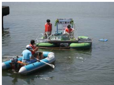
335 ヘドロ水浄化ロボット ウォーターエコ2号 凝集剤によってヘドロと河川水を 分離させる水質浄化ロボット
