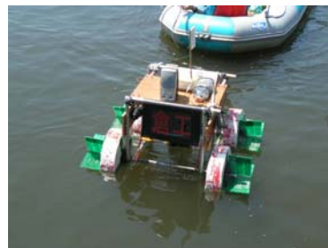
353 倉エタナバタ2号 資質浄化剤を散布して攪拌すると共に、浮いているゴミを回収する
