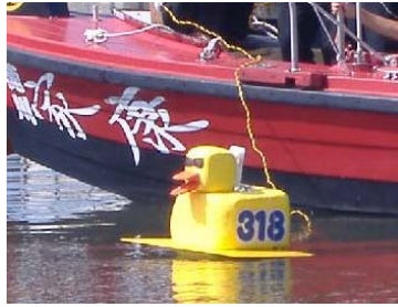
318 ガー子 水をろ過するガチョウ型ロボット
