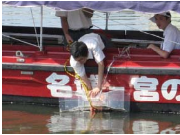
317 堀川エコロボット ASD2改 水流で発電しエアを水中に入れる
