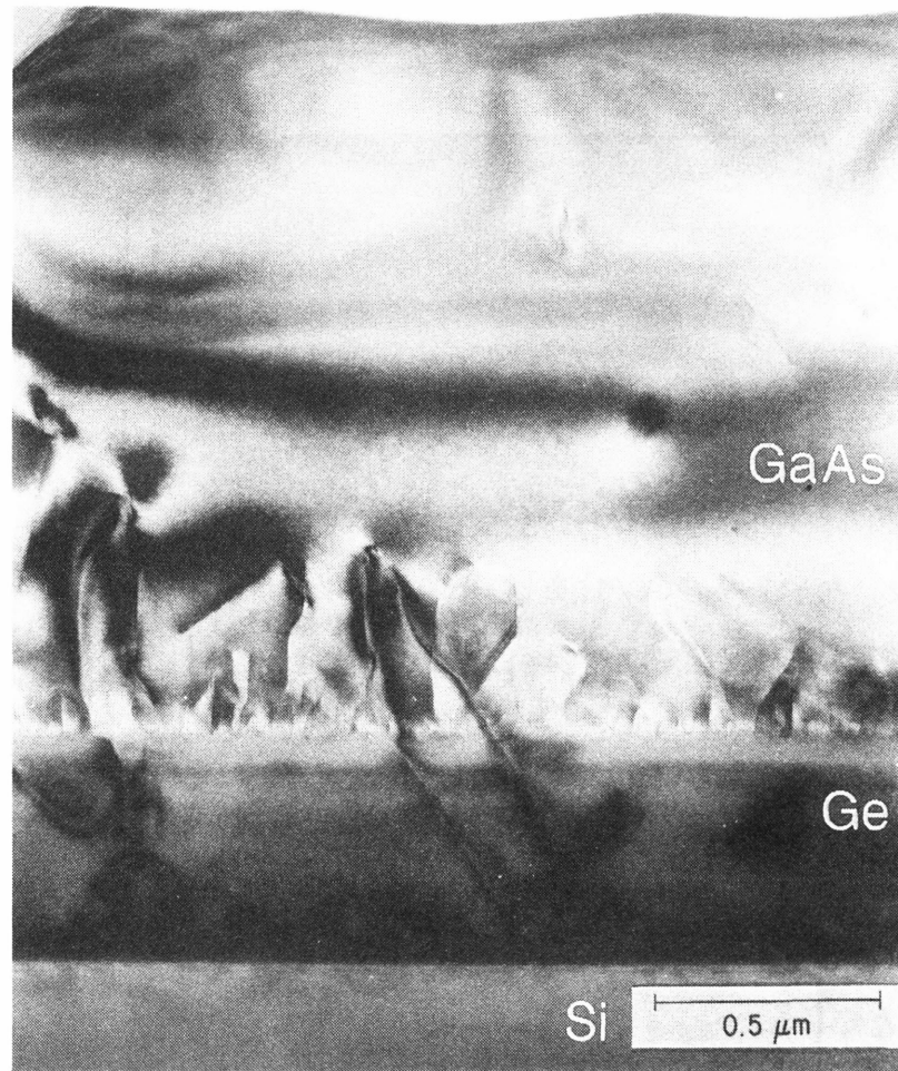
図 6 . 4 GaAs-on-Ge/Siの断面 T E M 像
