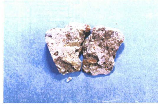
写真-2.4 加熱後の供試体 (VF-25%-U-300)
