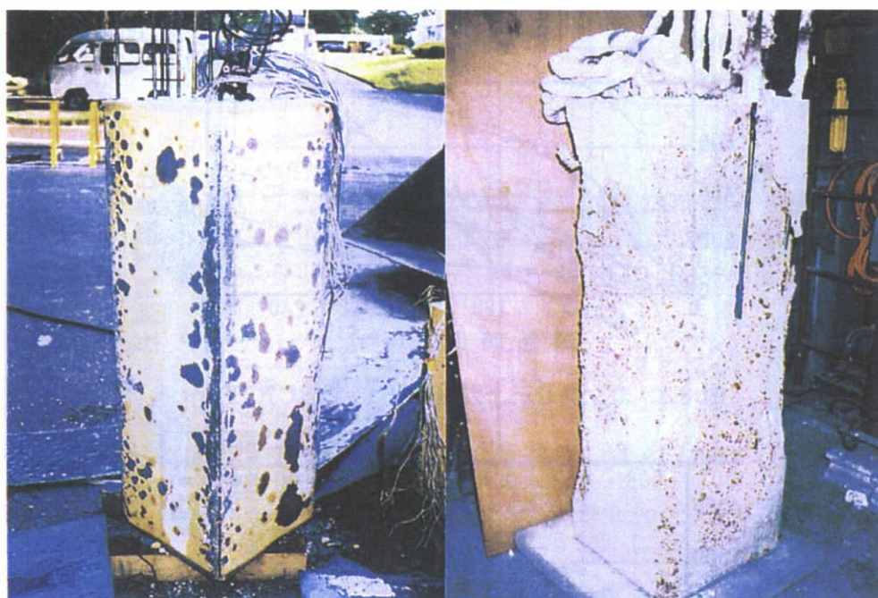
写真-6.2 加熱後の試験体の状態 (左：CS10-T, 右：RC10-T)
