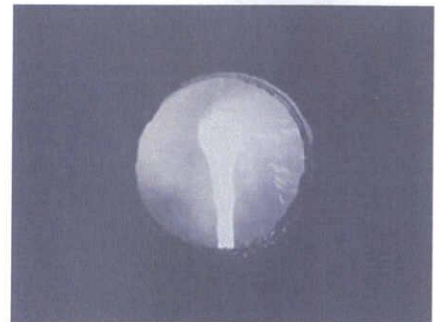
写真 2-1 高温ガス化溶融炉での出滓
