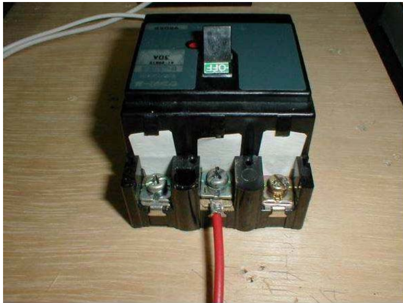
図 5-2 接触不良端子の様子
