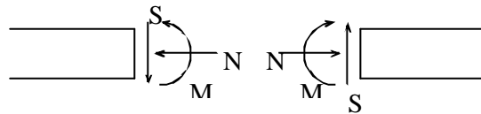
Figure A2-2 断面力 M, N, S の定義
