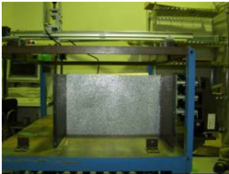
Photo 4-1 2次元掘削モデル試験装置
