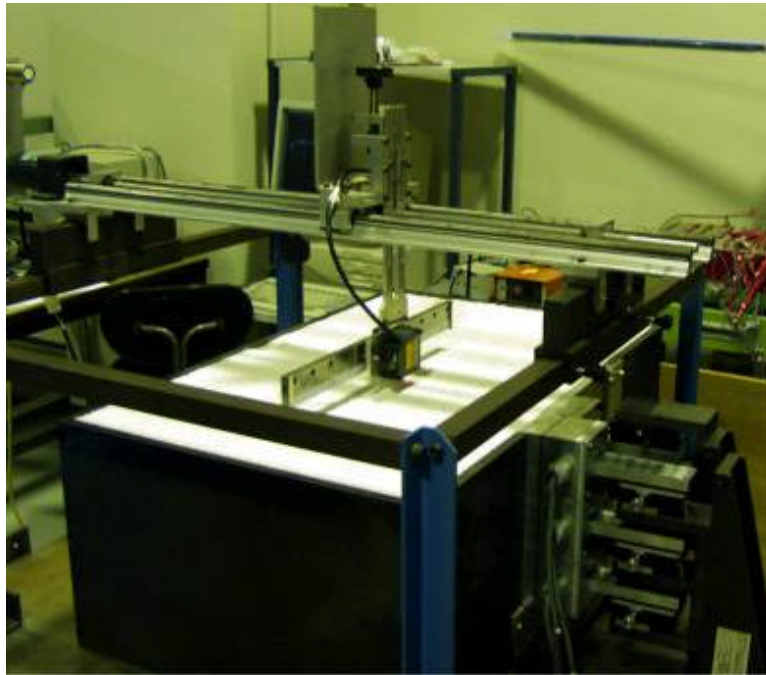
Photo4-3 3次元掘削モデル試験装置
