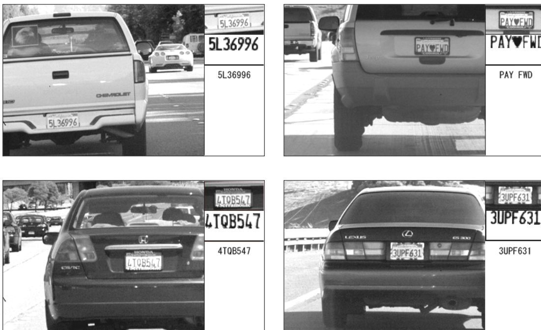
図5-16. ナンバープレートの認識結果例.
