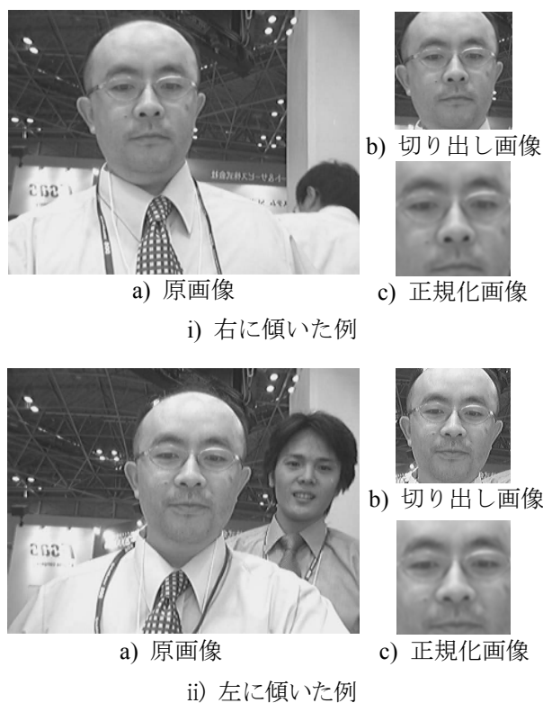
図3-2. 傾いた顔の正規化の例
