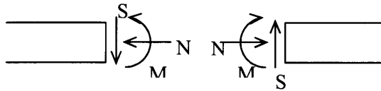
図 A2.2 断面力 M, N, S の定義
