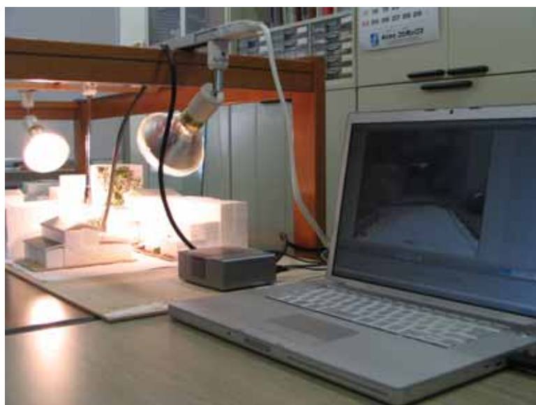
写真 6.10 模型空間撮影のための機材設置状況
