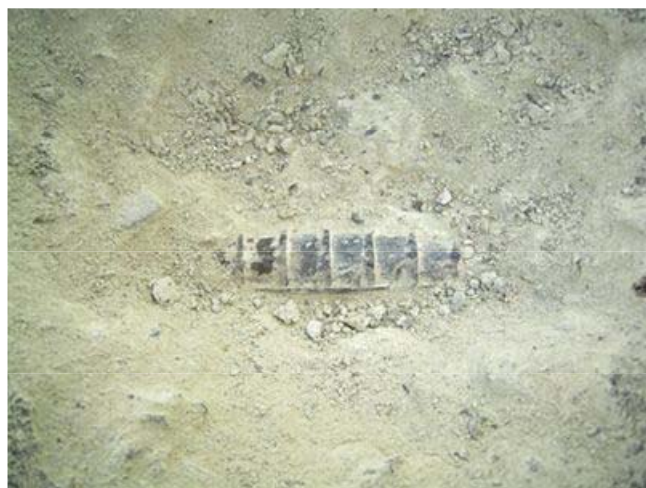
写真6-6 床版Ⅲ上り「健全部」で -404\text{mVvs.CSE} を示した箇所の鉄筋の状態
