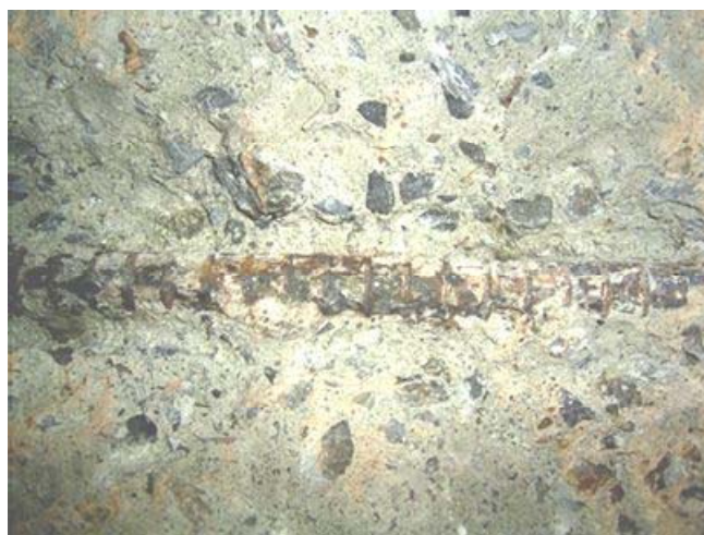
写真6-7 床版Ⅲ上り「損傷部」で-419mVvs.CSEを示した箇所の鉄筋の状態
