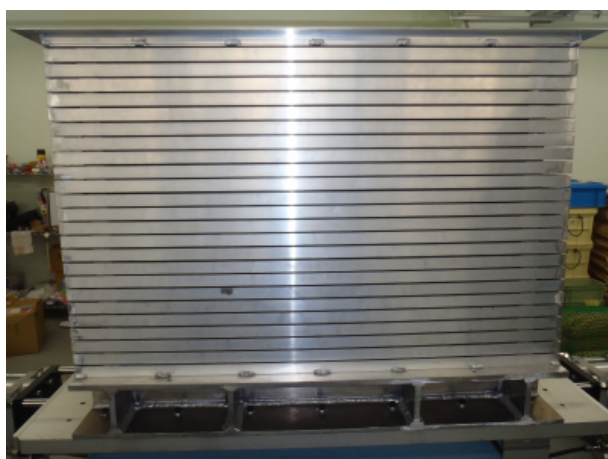
Fig. 2.1.2 せん断土槽
