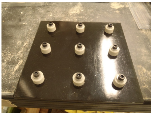
Fig. 2.1.6 杭基礎下端部固定治具
