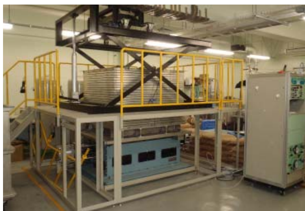
Fig. 2.1.1 空圧式振動台実験装置
