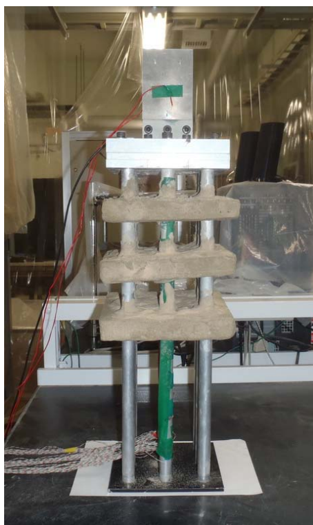
Fig. 2.1.21 Case3 : 多段式改良 (改良体間隔 2D)
