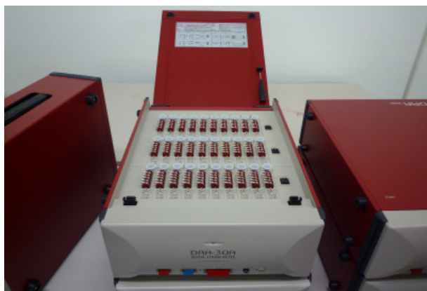
Fig. 2.1.3 多チャンネルデジタルひずみ測定器
