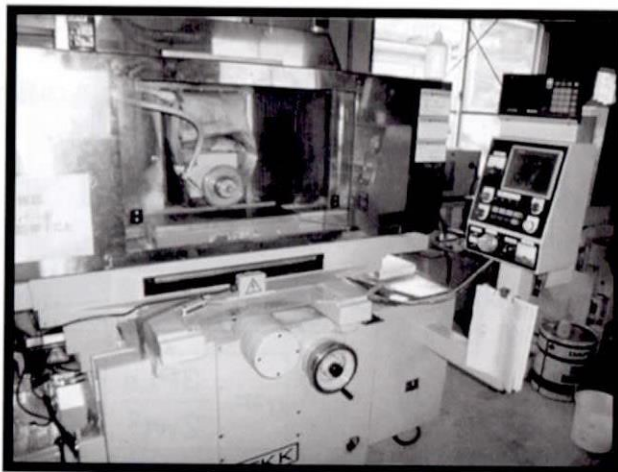
図 1.5 精密切断機による試料切断
