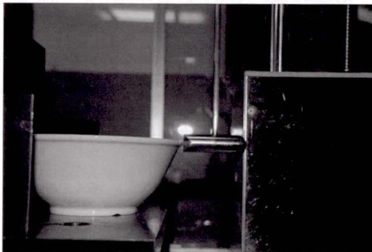
図 2.3 試料（強化磁器食器）とハンマー
