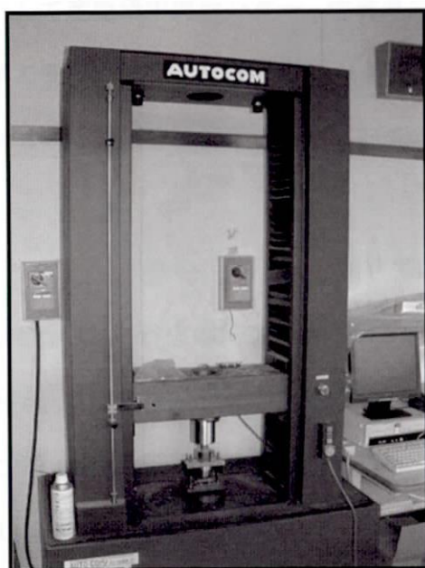
図 1.7 曲げ試験装置
