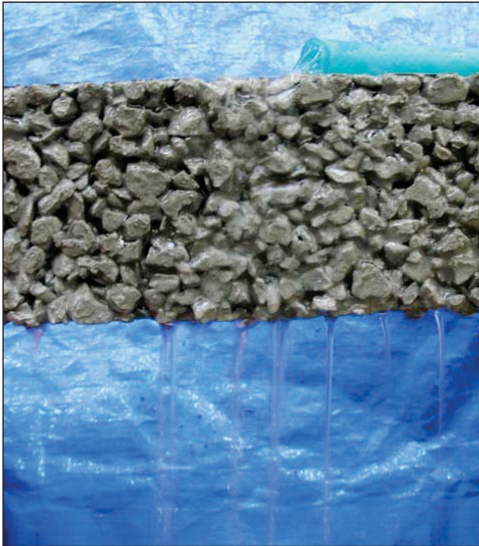
写真1-1 ポーラスコンクリート
