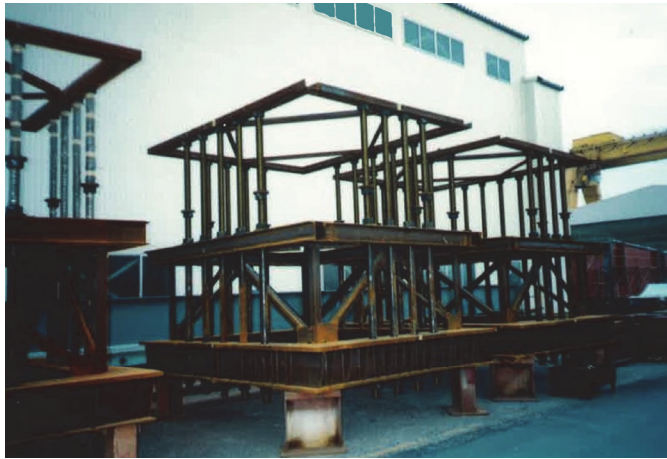
補図-1.2 杭方式のアンカーフレームと固定治具の写真
