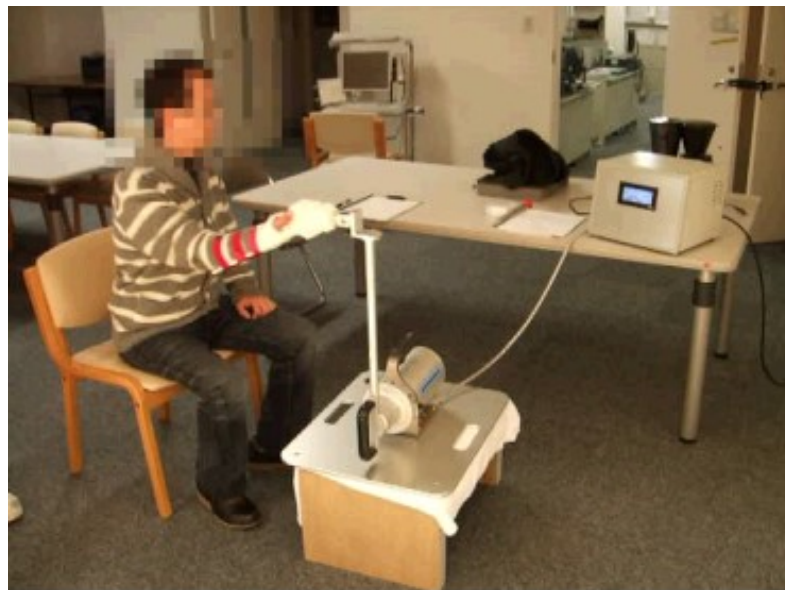
図 4.3 1自由度パッシブ型反力提示デバイス [65,66,70,71]
