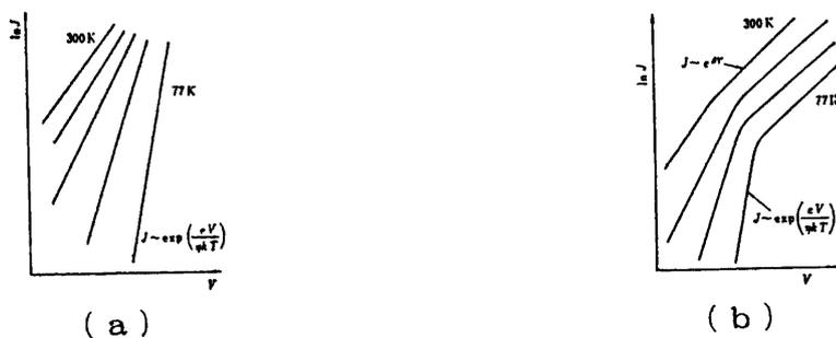
図 7. 4 格子定数が大きく異なるヘテロ接合の、測定温度に対する電流電圧特性の変化。(a) 2重ショットキーモデル、(b) 再結合-トンネルモデル
