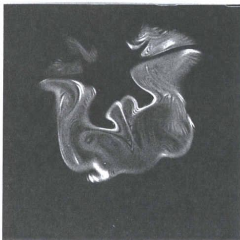
図 4-1-1 自由空間を並進する渦輪の正面の様子 ( Re = 1400 )
