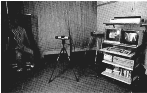
図2 人胴体非接触計測システム (スライドプロジェクタから被検者の体表面に格子点を投影し、その位置をテレビカメラで計測する。この結果をもとに三角測量の手法を用い、各格子点の3次元上の位置を計算し胴体形状を再構成する)
