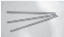
写真2 D10 異形鉄筋
