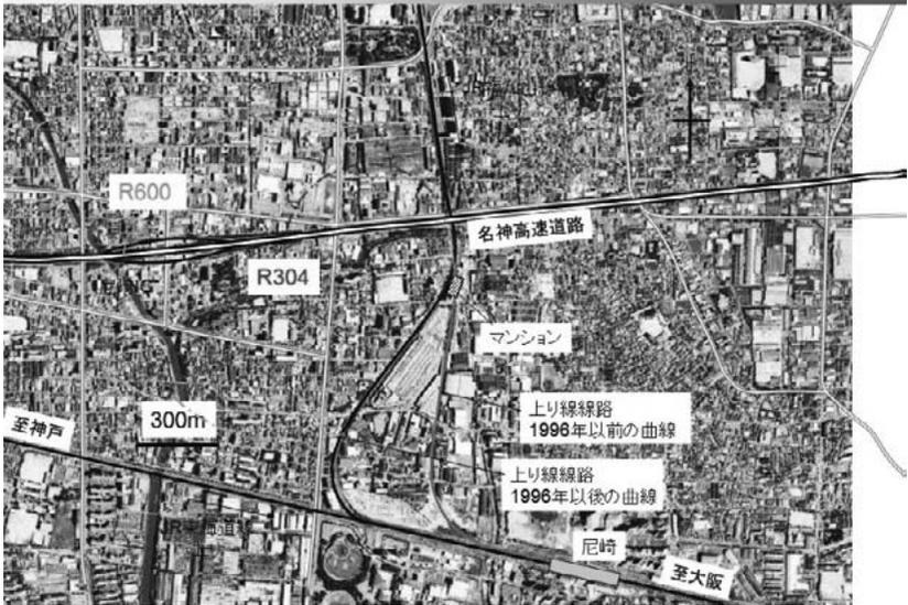
図 18: 事故現場の Google 航空写真。半径 600m の線路の跡が空き地として残っていることが分かる。
