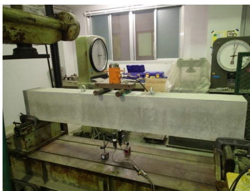
写真 4-3 荷重試験前の RC 梁部材の様子
