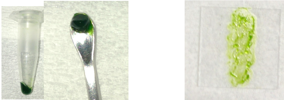
図 7-9 Alk-DKDKC 12 K、Bis-Alk-DKDKC 12 K により可溶化された PSI と Bis-Azide-PEG 2000 の Hüisgen 環化付加反応による溶液のゲル化挙動 (左)、得られたゲルをガラス板に塗布したもの (右)
