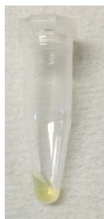
図 7-8 Alk-DKDKC 12 K 、 Bis-Alk-DKDKC 12 K と Bis-Azide-PEG 2000 の Huisgen 環化付加反応による溶液のゲル化挙動
