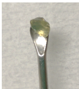
図 7-8 Alk-DKDKC 12 K 、 Bis-Alk-DKDKC 12 K と Bis-Azide-PEG 2000 の Huisgen 環化付加反応による溶液のゲル化挙動
