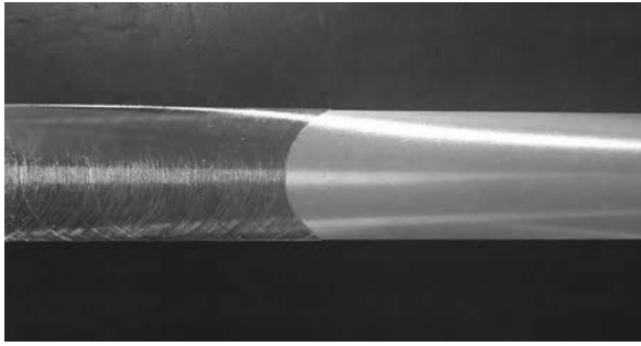
図5 真鍮 4枚刃⇔新品2枚刃
