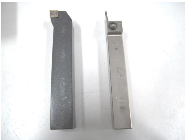
外形加工用バイト（左） 突切り・溝入れ用バイト（右）
