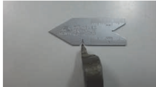
図9 製作したねじ切りバイト
