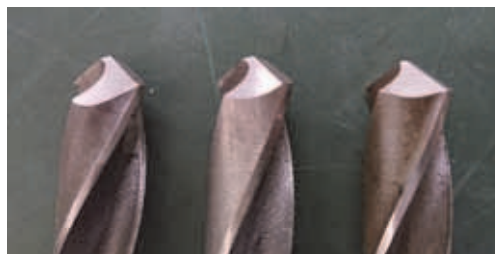
図2 研削したドリル（旋回/主軸） 左(旧)40°/65° 中央45°/50° 右50°/40°
