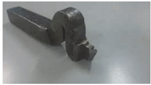
図8 製作したねじ切りバイト
