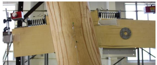
図5 門型試験体貫端部の変形 (1/5rad 時)
