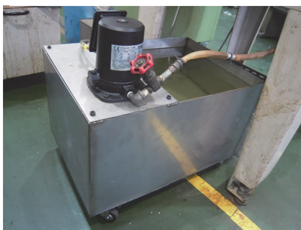
図5 完成した加工液槽一式
