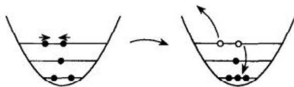
図 1.3: 蒸発冷却過程の説明図。高エネルギーを持つ原子を磁気ポテンシャルから逃がすことにより、ポテンシャル内の平均エネルギーが下がり、冷却される。[11]より引用。
