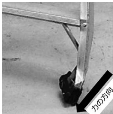
図 2-3 脚の変形
