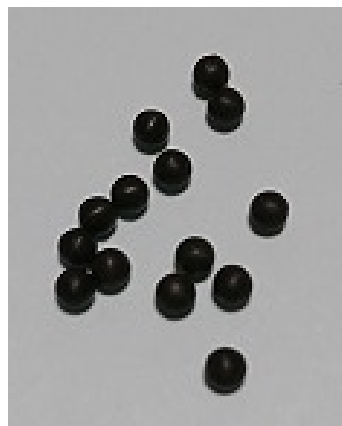
(d) Material: nitrile rubber NBR, diameter of particles: 3 mm
