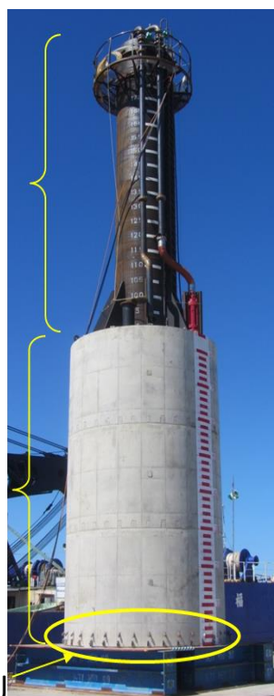
写真 2.1 RC 製試験体
