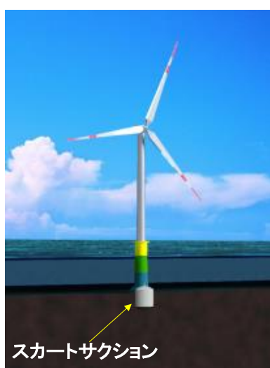
図 1.2 洋上風車への適用イメージ (左: モノバケツトタイプ, 右: ジャケツトタイプ)
