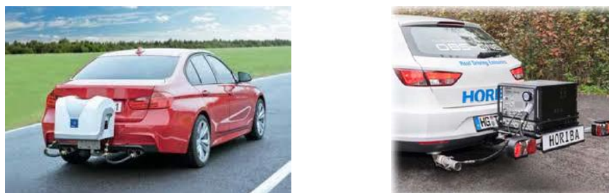
図 5 PEMS の車両搭載例
