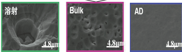
図9 各種製品のプラズマ照射試験後の組織比較
