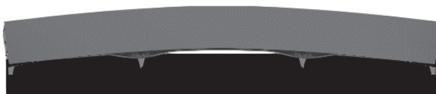
(b) 橋軸直角方向 1 次モード (T=0.51 s, 有効質量比 : 39%)
