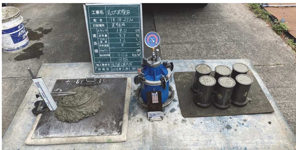
写真-4.6 スランプ試験及び塩分量測定の状態
