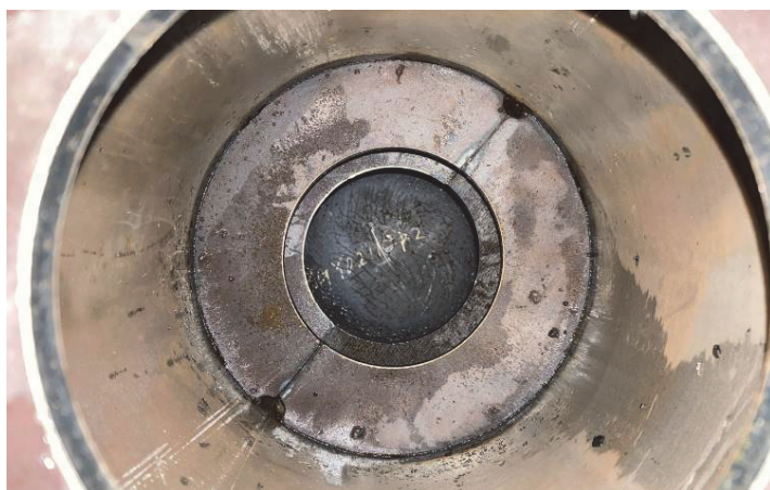
写真-4.3 実験供試体鋼管の内部構造
