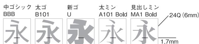
図 3-7 文字サンプルと縦線の太さの計測点
