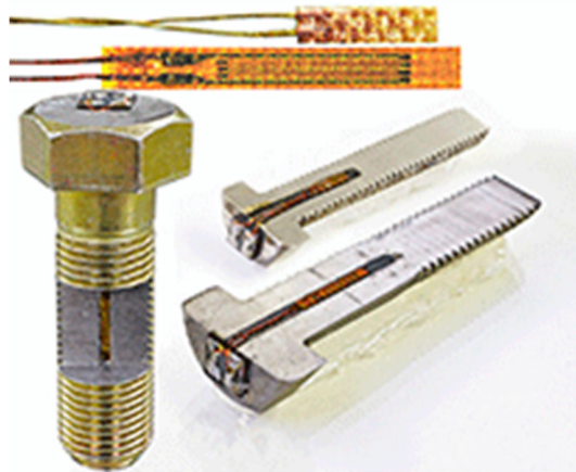
写真-4.9 ボルト用ひずみゲージ（東京測器研究所製）
