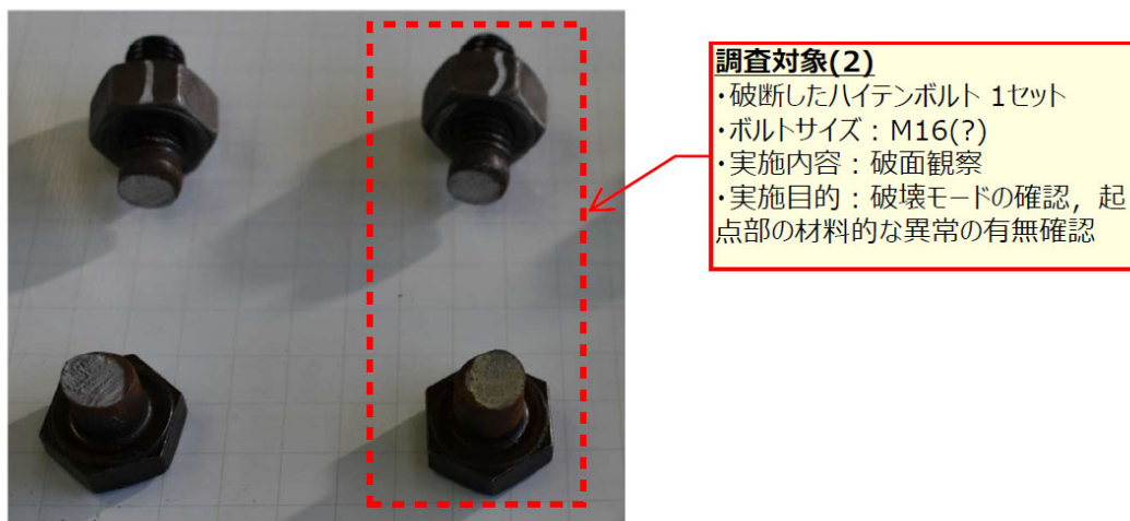
写真-4.5 ボルトの破断状況
