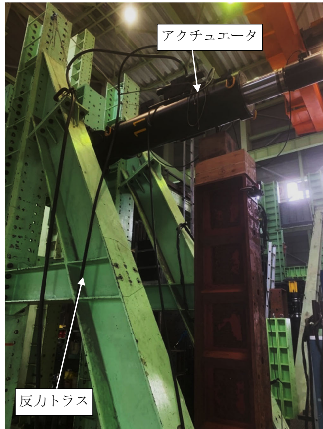
写真-4.4 4000kN アクチュエータと反力トラス
