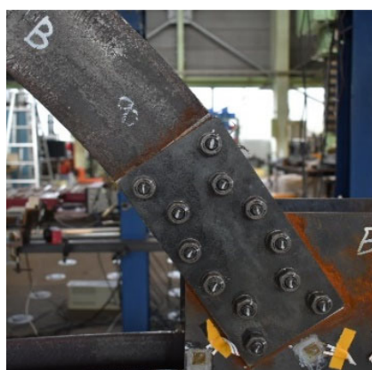
(c)ブレース材下端側の变形
