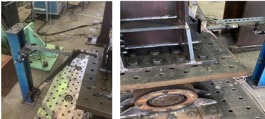
写真-4.7 下端部の棒変位計
