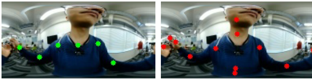
図 3.4 OpenPose を用いた 2D ポーズ推定結果 (左図) と提案手法の推定結果 (右図).
