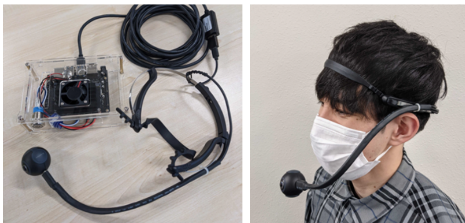
図 5.1 装着型 MoCap システムのハードウェア構成と装着例.
